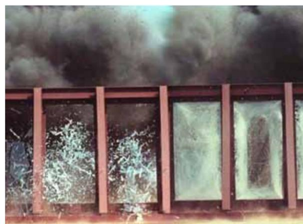
Рис. 1. Степени разрушения различных видов остекления при взрыве
